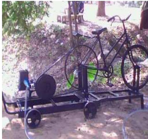
รูปที่ 3.13 แสดงรูปชุดจักรยานปั่นน้ำเอนกประสงค์
